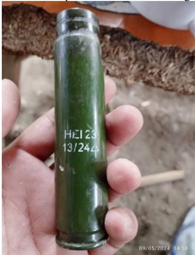
Una cartuccia scartata da un proiettile incendiario ad alto potenziale esplosivo (HEI) da 23 mm, molto probabilmente sparato da un pod di mitragliatrice GSh-23 montato su un jet da combattimento pilotato dall'esercito del Myanmar. Il proiettile è stato prodotto localmente in Myanmar nel 2024. È stato trovato nel sito di un attacco aereo su un monastero nella regione di Magway in Myanmar il 9 maggio 2024.
